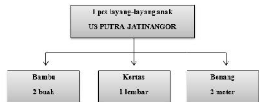
Gambar 1. Struktur Produk Layang-layang
